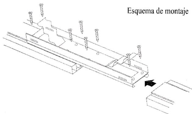
Insertar las dos guías cortadas en la grapa de unión. Utilizar la misma grapa de unión como referencia para hacer los 4 agujeros de sujeción en cada guía de 3,5mm de diametro. Fijar la grapa con los tornillos entregados.
